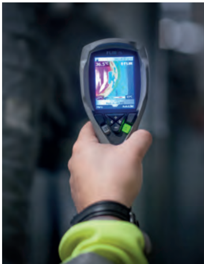
Gebruik van thermografie voor het vaststellen van leidinglekkages.
